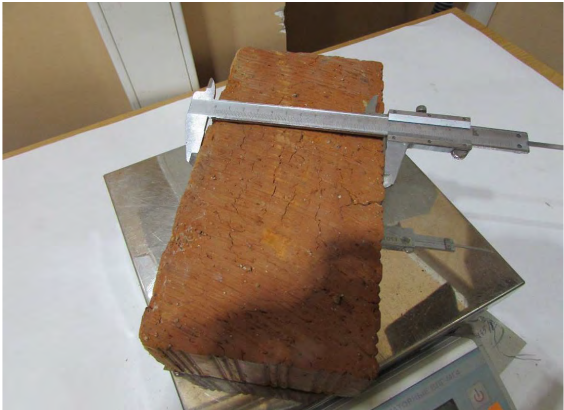
Рис. 4.6.2. Определение геометрических размеров кирпичных образцов
