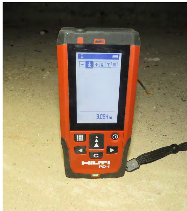
Рис. 2.4. Замер высоты помещений подвала при помощи лазерного дальномера HILTI PD-1
