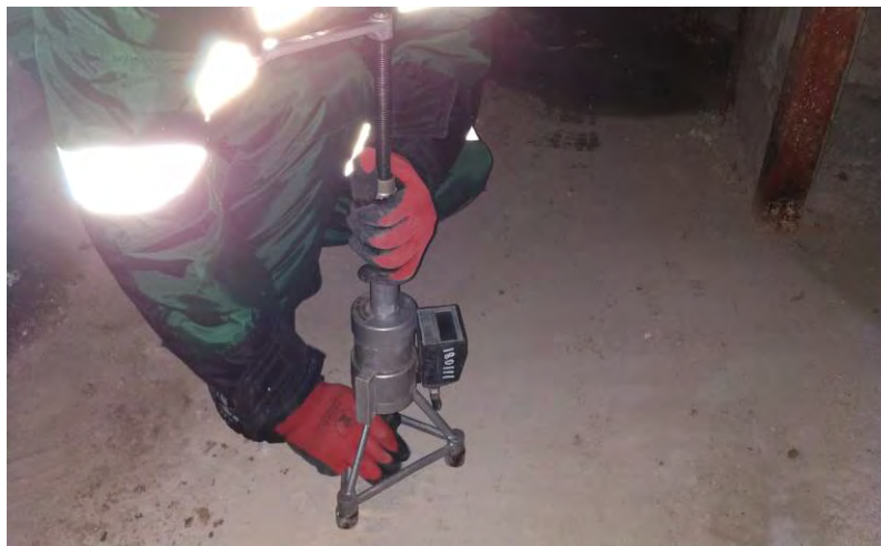
Рис. 4.2.5. Установка тяги прибора «ПОС-50МГ4»
