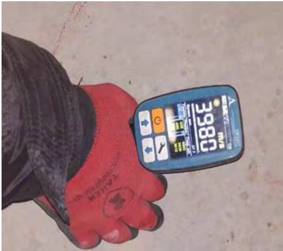
Рис. 4.3.1. Определение прочности бетона ультразвуковым методом прибором «УК 1401»
