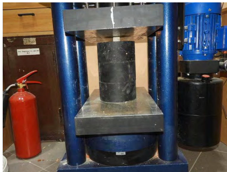
Рис. 4.7.3. Определение предела прочности при сжатии контрольных образцов-кубов раствора
