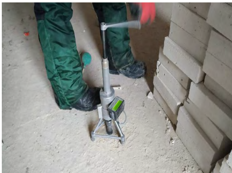
Рис. 4.2.6. Проведения испытаний прибором «ПОС-50МГ4»
