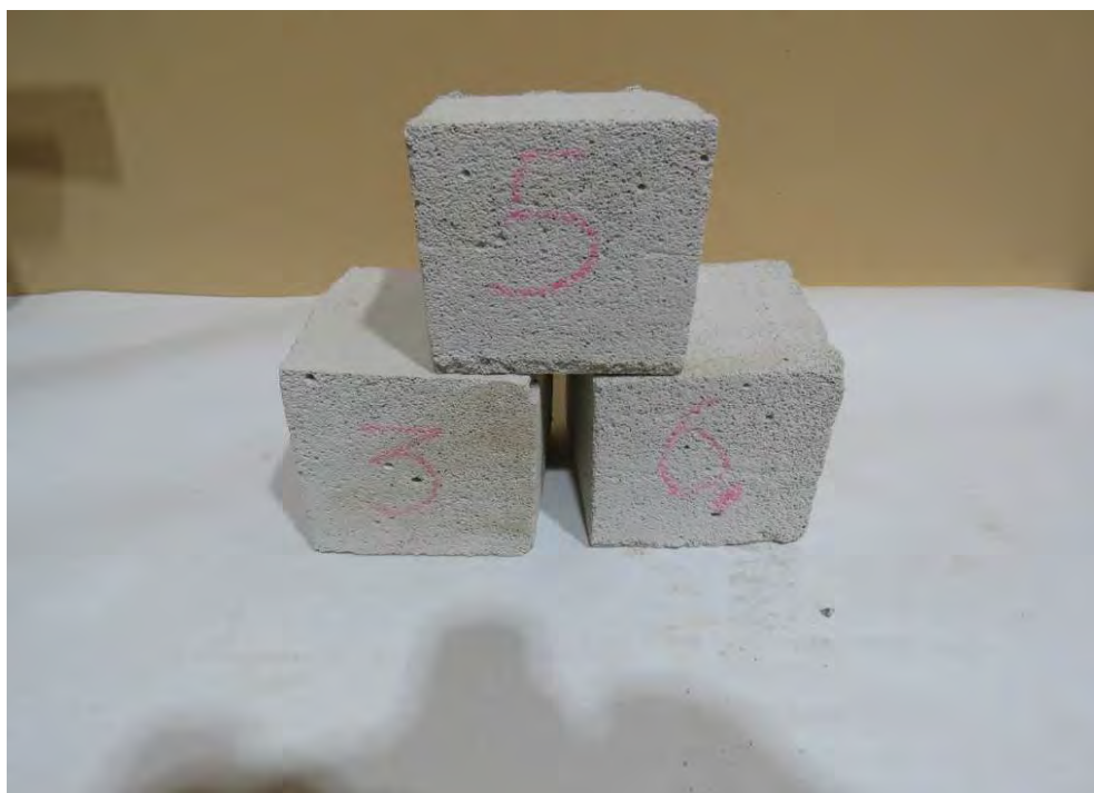
Рис. 4.5.2. Общий вид контрольных образцов-кубов, выпиленных из центральной части блока из ячеистого бетона
