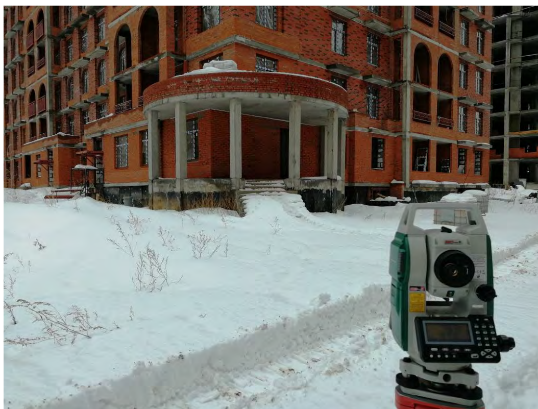
Рис. 2.6.1. Определение отклонений от вертикали и горизонтали строительных конструкций жилого здания при помощи электронного тахеометра «Sokkia RX-550»
