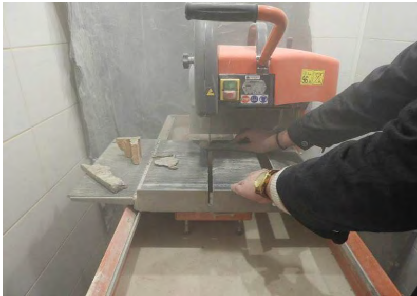
Рис. 4.7.1. Изготовление контрольных образцов-кубов, отобранных из горизонтальных швов кирпичной кладки
