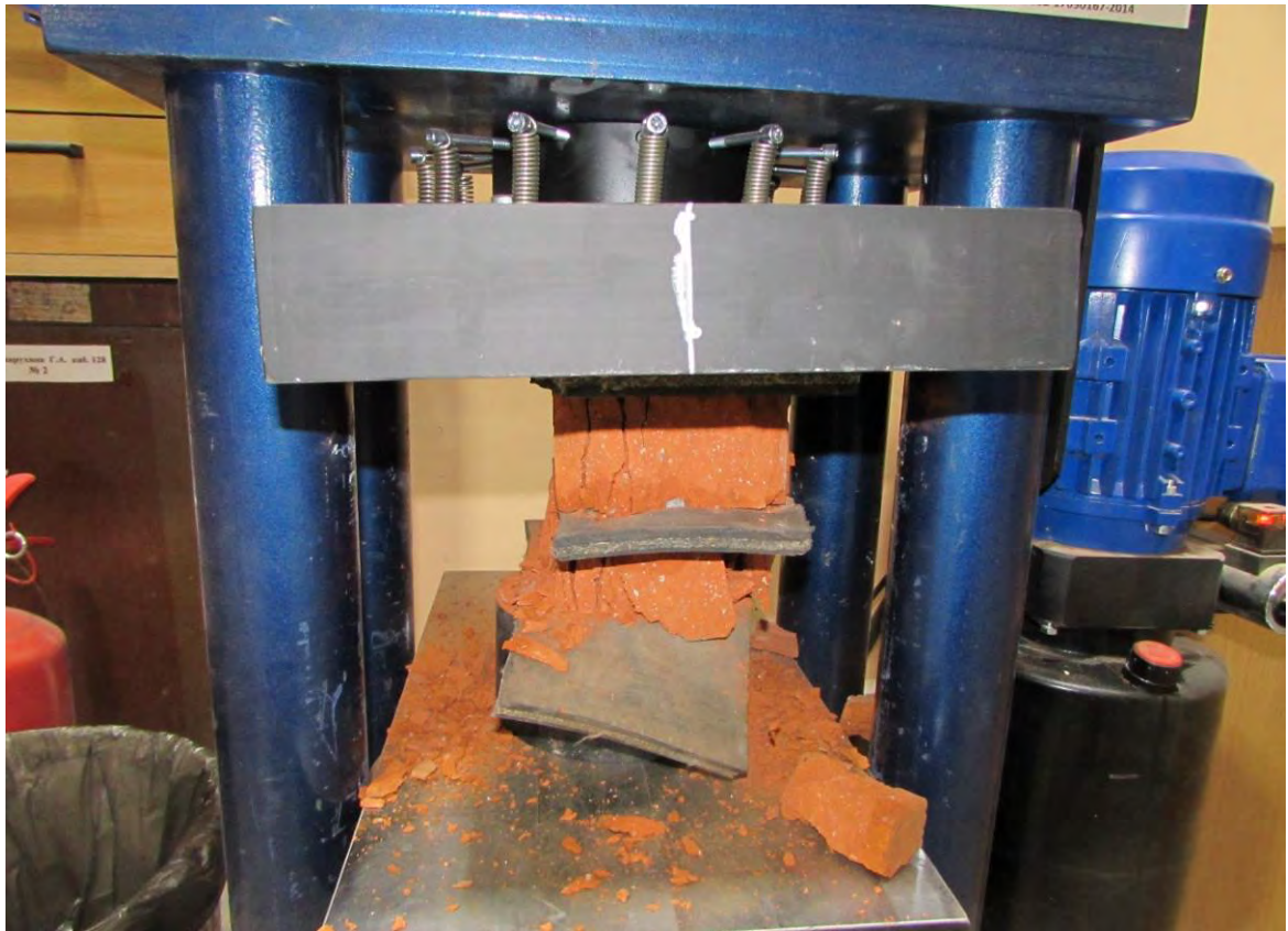
Рис. 4.6.3. Общий вид образцов после проведения испытаний по определению предела прочности на сжатие
