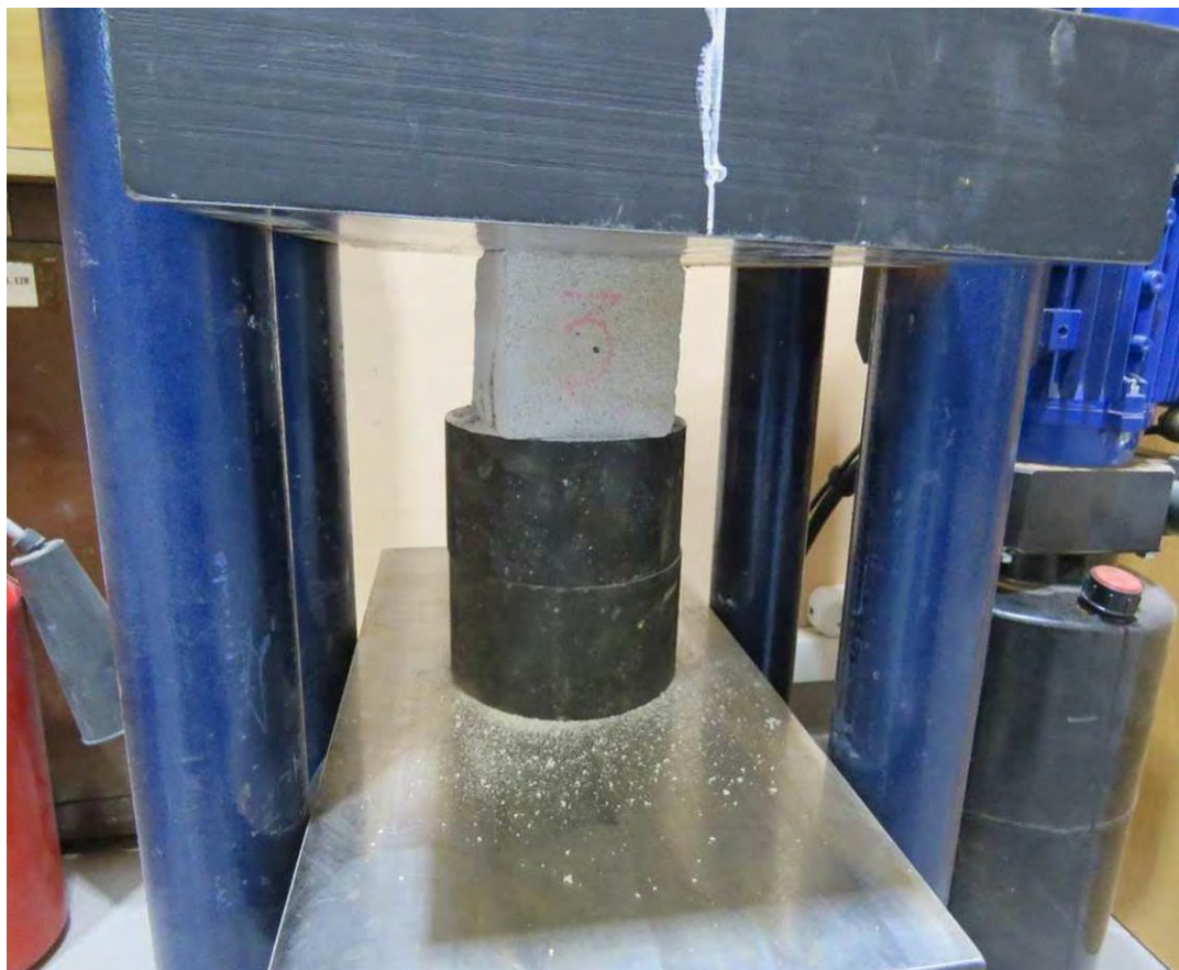
Рис. 4.5.4. Установка образца в испытательную машину
